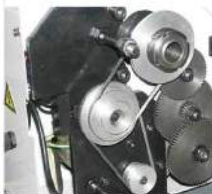
Рис. 3-8: Изменение положения приводного ремня
